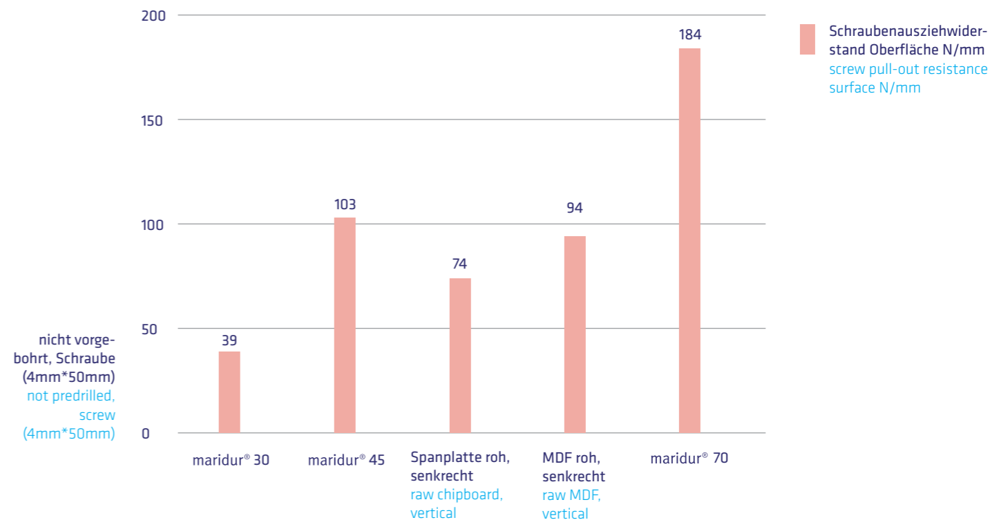
Vergleich Schraubenauszugswiderstand in Anlehnung an EN 320 (Bestimmung des achsenparallelen Schraubenauszugswiderstands) Comparison of screw pull-out resistance based on EN 320 (Determination of the axis-parallel screw pull-out resistance)
